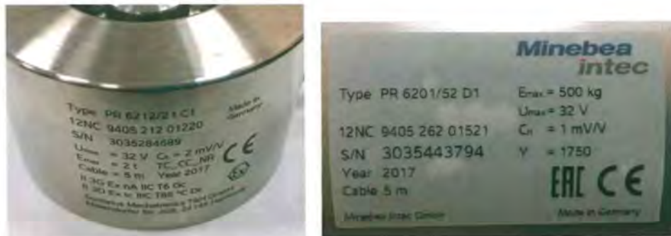
Рисунок 2 - Маркировочная табличка датчиков весоизмерительных PR 6201, PR 6212
