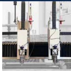
**Sistema di teste multiple automatiche gestito da controllo numerico.**
