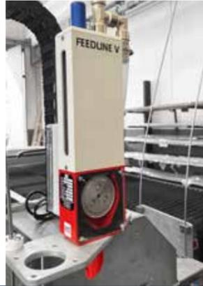
**Mini Hopper di dosaggio controllato dell'abrasivo.**
