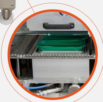
Termosigillatrice automatica mod. YPSILON idonea al confezionamento di prodotti alimentari in contenitori preformati con film termosalvanti da bobina. La macchina è espressamente concepita per lavorare nell'industria alimentare.
