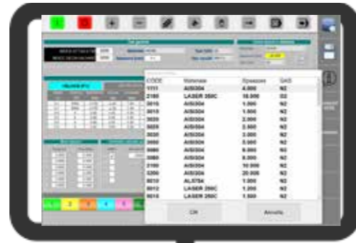
Caricamento parametri di taglio da data base tecnologico interno. Cutting parameters from internal technological database.
