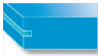
Flat edge with edge grooving.
