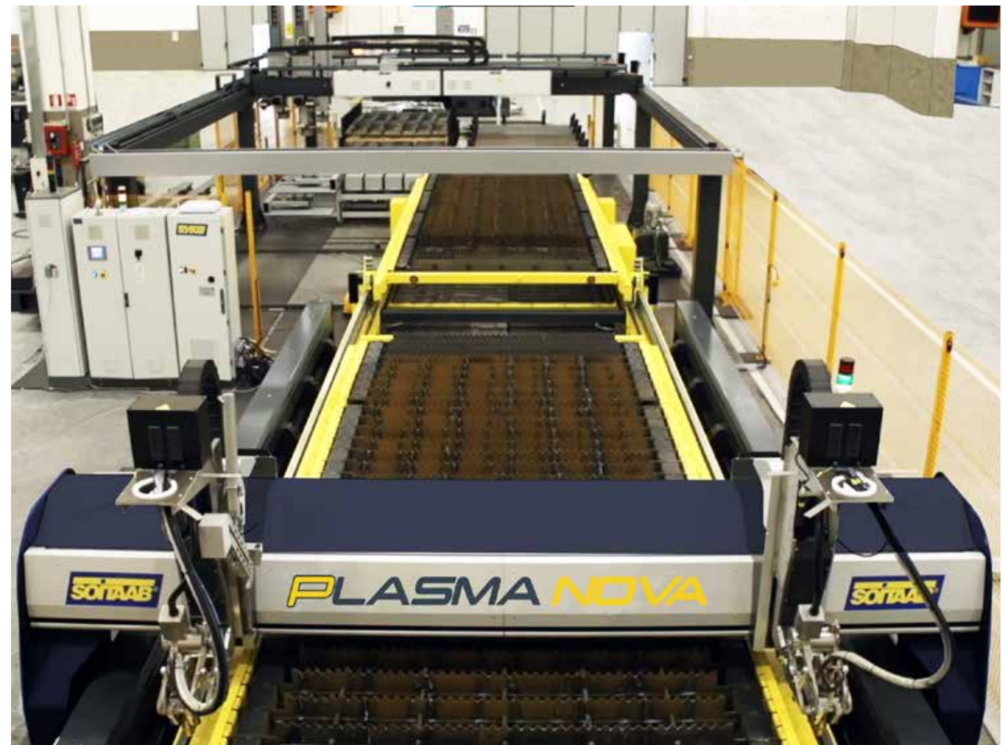
Magnete per lo scarico dei pezzi tagliati
