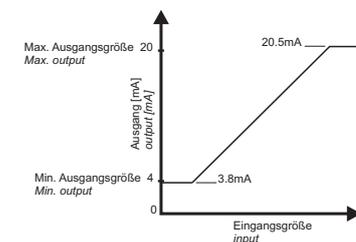
Ausgangssignal (Ausgangsgröße 4-20mA) bei Unter- bzw. Überschreitung der Eingangsgröße
