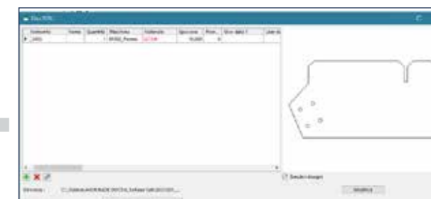
Importazione delle informazioni riguardanti il materiale, lo spessore e le diverse lavorazioni (Foratura con mandrino - utensile, maschiatura con il maschiatore, cianfrino per il taglio plasma).
