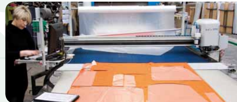
CNC-Zuschneiden CNC cutting
