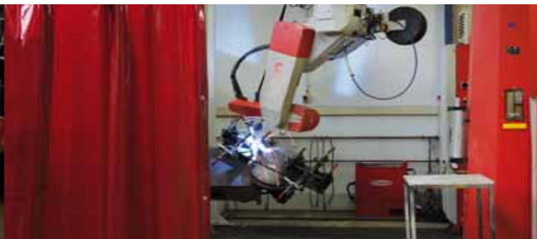
CNC-Schweißen CNC welding
