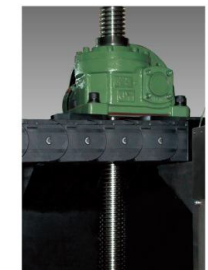
▲ Crossrail Hoist Motor
