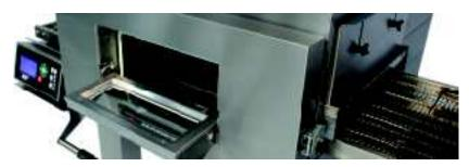
Il flusso di aria calda destinata alla cottura dei prodotti è ottenuto dal passaggio forzato dell'aria stessa attraverso i diffusori soffianti. La calibratura del flusso può essere facilmente effettuata agendo manualmente sulla maggiore o minore occlusione della sezione di passaggio di uno o di entrambi i diffusori superiore ed inferiore (non per T97G).
