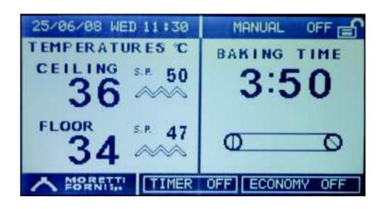
È inoltre possibile impostare 2 diverse temperature per cielo e platea (con un delta massimo di 20°C) per quei prodotti che necessitino di maggior calore nella parte bassa (suolo) o alta.
