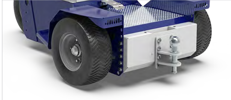
KUGELHAKEN (HAKEN MIT STIFT Ø20-25)
