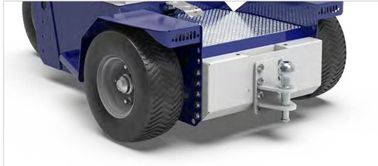
ATTEPAGE MULTIFONCTIONNEL (BOULE + GOUPILLE Ø20-25)
