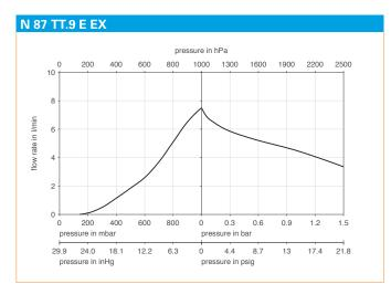
N 87 TT.9 E EX <sup>|</sup> PUMP DOWN TIME FOR 5 LITER VESSEL
