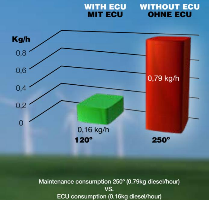
Energieverbrauch bei einer Haltetemperatur von 250° (0,79kg Diesel/Stunde) gegenüber Energieverbrauch ECU (0,16 kg Diesel/Stunde)
