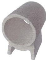
**Glührohr** zur Senkung der Abgastemperatur, Erhöhung der CO<sub>2</sub>-Werte, Verringerung der Rußzahl .
