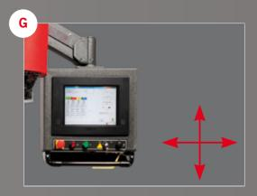
G: OPERATOR **CONTROL PENDANT CAN BE ADJUSTED** IN 6 DIRECTIONS.
