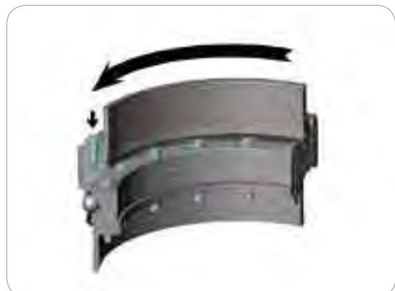
Figura 7. Comprobación de giro de la estructura secundaria
