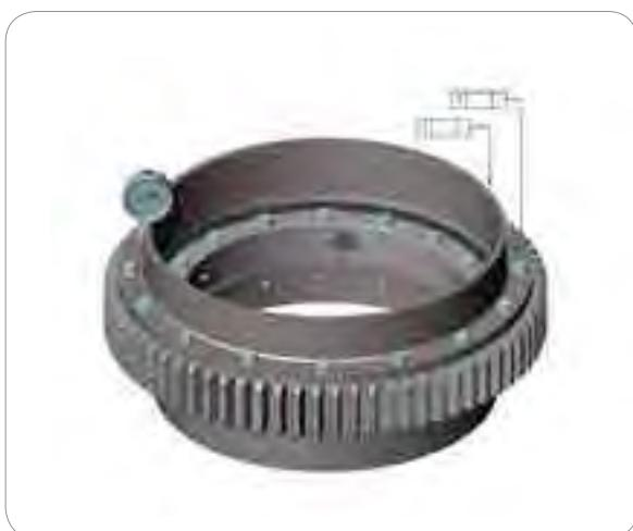
Figura 8. Medición del juego de inclinación
