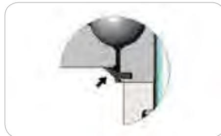
Existen diferentes perfiles de sellado en función de los requisitos. El material estándar es el elastómero sintético NBR, cuyas propiedades son una gran resistencia al aceite y a la grasa, así como al desgaste. Las temperaturas de operación pueden estar entre -40°C y 80°C.
