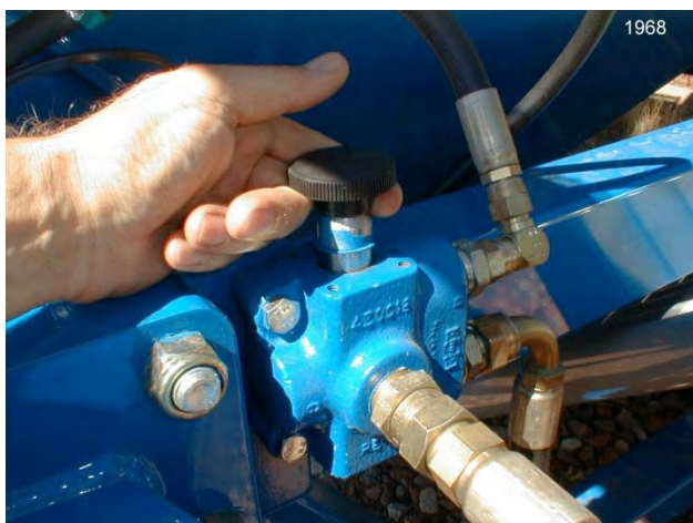
Fig. AO6 Diverter Valve.
