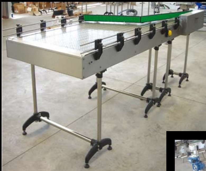
POLMONE DI CARICO MANUALE A INIZIO LINEA ACCUMULATION TABLE, LINE BEGINNING, FOR MANUAL LOADING TABLE D'ACCUMULATION MANUELLE AU DÉBUT DE LIGNE
