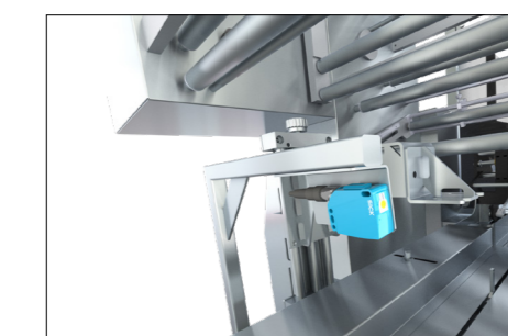
"No product-No bag" function Fotocellula di lettura prodotto
