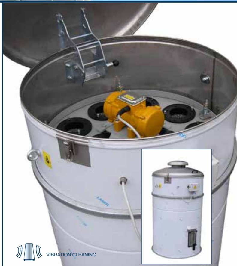
ESECUZIONE SENZA ASPIRATORE ASSEMBLY WITHOUT ELECTRIC FAN
