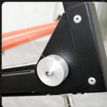
Bobina con filo di ricambio Spare cutting wire
