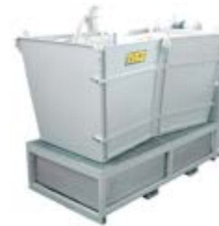
Sistema di rimozione abrasivo automatico. Studiato per rimuovere l'abrasivo utilizzato durante il processo di taglio. All'interno della vasca del tavolo di taglio vi sono degli ugelli che agitano l'acqua spingendo l'abrasivo in sospensione verso gli ugelli di aspirazione. L'acqua aspirata con un elevato contenuto di abrasivo viene mandata nelle tramoggia di decantazione e tramite un filtro a sacco si separano l'abrasivo e i residui di taglio dall'acqua. L'acqua filtrata viene rinviata nel bacino di taglio. Questo sistema evita fermi macchina per operazioni di pulizia.
