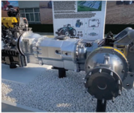
Deutz Weichai complete CVT transaxle.
