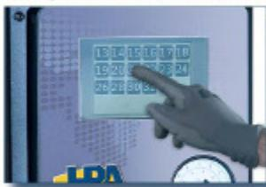
Impostazione dimensione ruote in pollici (13" + 32") ed autoposizionamento radiale ottimale della stessa rispetto al "revolver" automatico.
