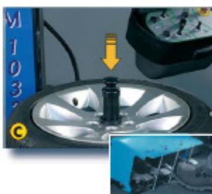
A. Inserimento maniglia con cono di bloccaggio.
