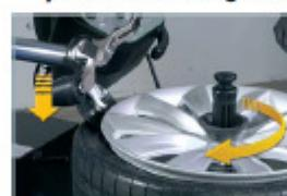
Il disco stallonatore del revolver preme idraulicamente sul pneumatico e la contemporanea rotazione della ruota facilita la stallonatura superiore.
