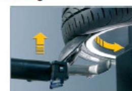
Successivamente, il disco stallonatore inferiore preme da sotto e la contemporanea rotazione della ruota facilita la stallonatura inferiore.
