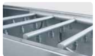
95 inyectoros inox (desmontables). 95 st.st. nozzles (detachable).
