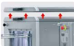
Tapa superior extraíble. Detachable cover.
